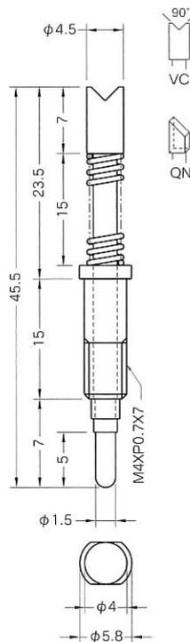
上記記載寸法の単位はmm。先端形状の詳細寸法は先端形状別一覧表 (P262~) のCPM40S、CPEM40S、CPRM40Sを参照 (CPUM、CPUEMシリーズとしての記載はありません)。
